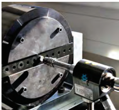
Obr. 6: Kontrola koeficientu smykového tření. Zařízení vyhodnocuje průběh tření pod hlavou a v závitě šroubu při utahování. Šroubová laboratoř disponuje mechanickým dotykovým konturografem, který snímá okraje spojovacích prvků a závitů a porovnává je s daty. Následně se stanovují odchylky a v simulační stanici se analyzují fáze utahovacího procesu.
