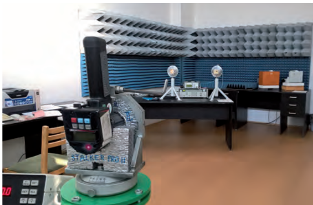
Obr. 6: Měření vysílacího kmitočtu rychloměru mikrovlnným čítačem s útlumovými jehly na pozadí
