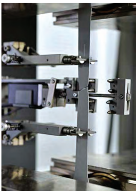
Obr. 5: Pevnost v tahu. Určuje se pomocí trhacího stroje, který stanoví hodnoty pevnosti v tahu i meze pružných a trvalých deformací. Snímek ilustruje pásek hlubokotažné oceli užívané pro vnější část karoserie.
