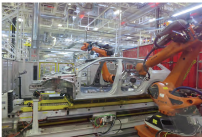
Obr. 3: In-line měření svařené karoserie. Optické měřicí systémy implementované na robotická ramena.
