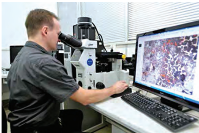
Obr. 4: Metalografický mikroskop. Pod mikroskopem na obrázku se nachází sedlo ventilu ze sintrované oceli.
