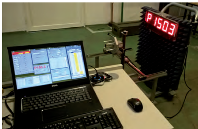
Obr. 8: Simulátor VFM, kterým se provádí simulovaná terénní zkouška
