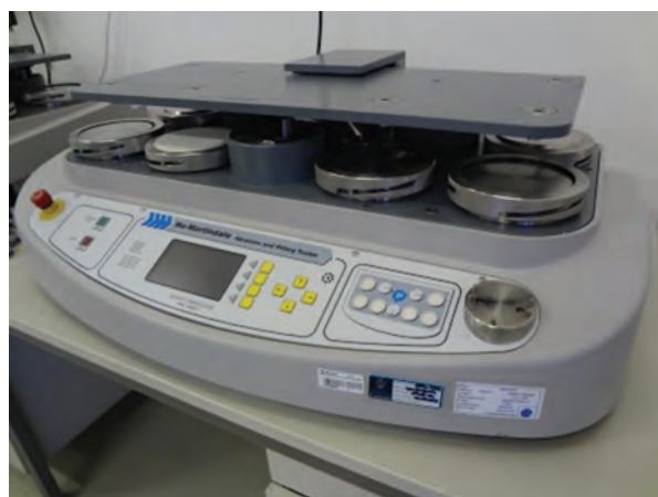
Obr. 8: Zkouška oděru textilií – Martindale. Hodnocení odolnosti potahových textilií na sedačky vozu proti oděru o normovanou tkaninu. Hodnotí se opěrka hlavy a obložení dveří, středový pás sedadla a bočnice sedadla. Dále se hodnotí odolnost textilií po oděru suchým zipem, kdy se namáhaná textilie porovnává vůči etalonům. Další zkouškou na tomto zařízení je zkouška žmolkování – vliv vzájemného působení normované a potahové textilie za vzniku tzv. žmolků.
