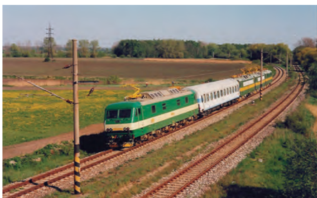
Obr. 7: Měření trakčních charakteristik (měřená lokomotiva a brzdové lokomotivy)
