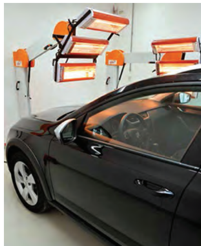
Obr. 7: Emisní komora. Emisní látky se měří při dvou teplotách: pokojové 23 °C a na 65 °C (s tolerancí \pm 5 °C). Snímek ukazuje zahřívání vozu pomocí infračervených zářičů.
