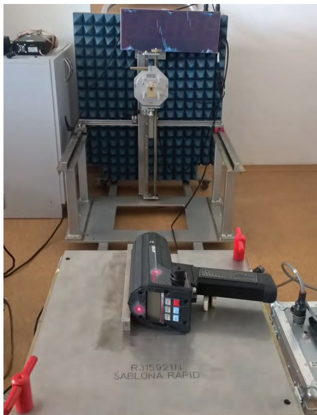
Obr. 4: Rychloměr Stalker při kalibraci na VFM simulátoru
